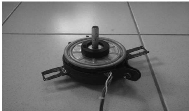
ภาพที่ 3 มอเตอร์พัดลมของเครื่องปรับอากาศอินเวอร์เตอร์
