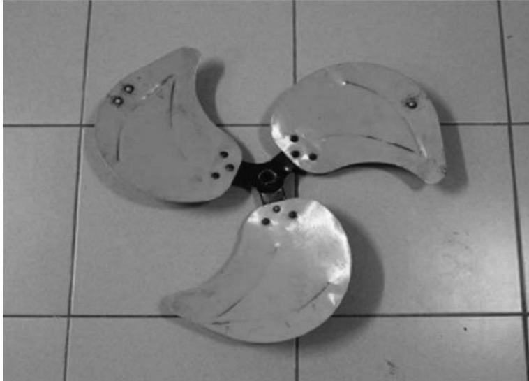
ภาพที่ 18 ใบพัดแบบโลหะ มีการถ่วงสมดุลของใบพัดแล้ว
