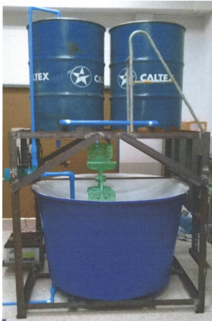
ภาพที่ 2 ชุดผลิตกระแสไฟฟ้าด้วยระบบน้ำแบบสูบกลับขนาดเล็ก
