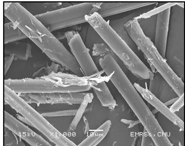
รูปที่ 2 ลักษณะสัณฐานวิทยาของเศษไหมที่ลดความแข็งแรงโดยใช้สารละลายโซเดียมไฮดรอกไซด์เข้มข้น 15% ตรวจสอบโดยใช้เทคนิค SEM
