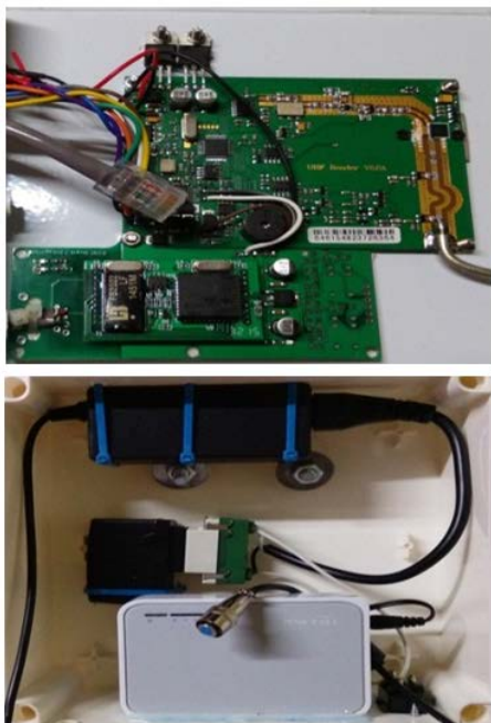
ภาพที่ 3 การศึกษาวงจร Module Reader และ TCP/IP Convert และการติดตั้งอุปกรณ์
