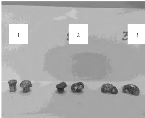
ภาพที่ 6 ลักษณะการผิวดรูปของหัวกระสุนในการทดลอง
