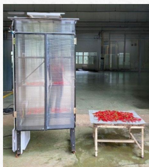
ภาพที่ 3 แสดงการทดสอบการอบแห้งพริกด้วยตูบแห้งพริกแบบพับเก็บได้กับการตากแดด ณ ช่วงเวลาเดียวกัน
