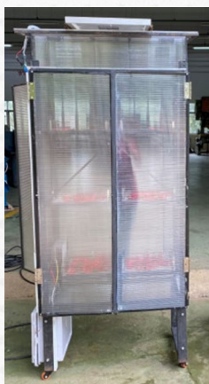
ภาพที่ 4 การทดสอบเพื่อการศึกษาระยะเวลาที่ใช้ในการอบพริกด้วยตู้อบแห้งพริกแบบพับเก็บได้
