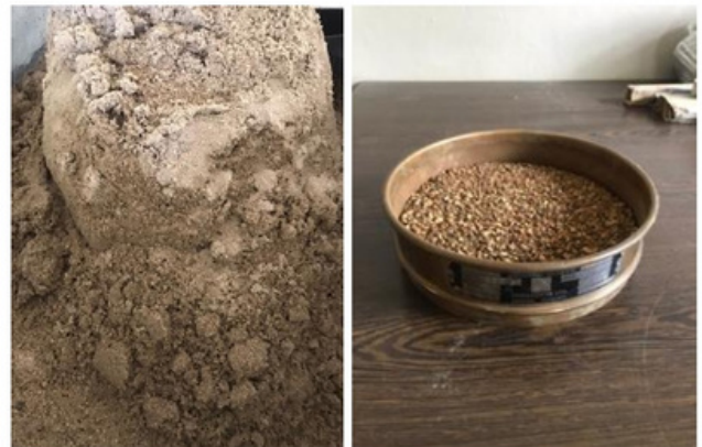
ภาพที่ 4.1 ทรายจากท้องถื่นขนาดเส้นผ่านศูนย์กลาง 0.850 มิลลิเมตร
