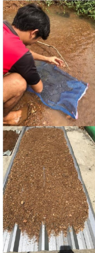
ภาพที่ 4.1 ทรายจากท้องถื่นขนาดเส้นผ่านศูนย์กลาง 0.850 มิลลิเมตร
