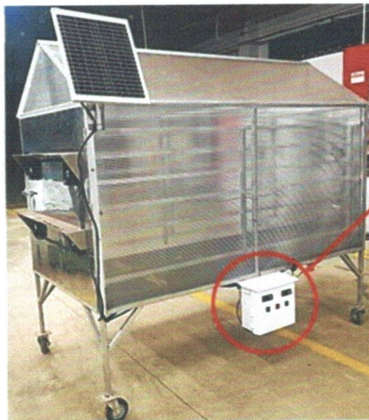
ภาพ 5 ต้นแบบเทคโนโลยีการอบแห้งแบบป้องกันรังสีพลังงานแสงอาทิตย์ต้นทุนต่ำ สำหรับกลุ่มวิสาหกิจชุมชนกลุ่มดวงทอง จังหวัดเพชรบูรณ์
