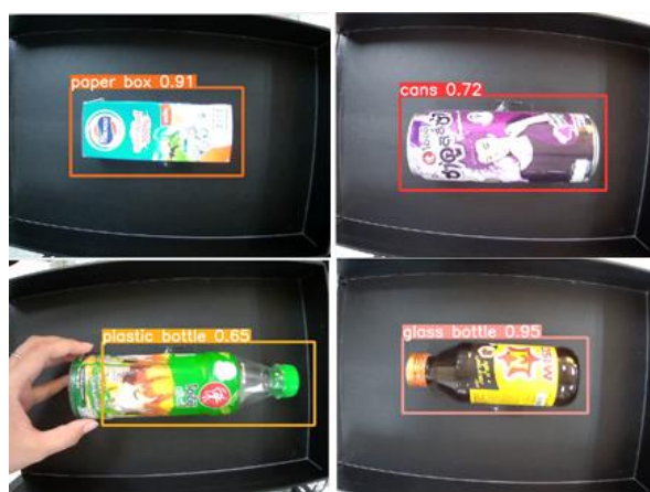
ภาพที่ 5 การทดสอบการคัดแยกขยะของเครื่องคัดแยกขยะรีไซเคิลทั้ง 4 ประเภท
