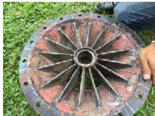
ภาพที่ 1 ใบกังหันน้ำและ ใบนำร่องทางเข้า (Guide vane) จำนวน 16 ช่อง
