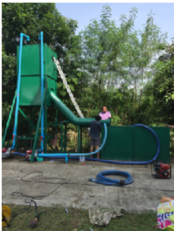
ภาพที่ 2 องค์ประกอบรวมของกังหันน้ำหัวน้ำต่ำต้นแบบสำหรับผลิตกระแสไฟฟ้าขนาดเล็ก
