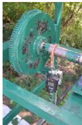
ภาพที่ 3 การทดสอบประสิทธิภาพกังหันน้ำหัวน้ำต่ำต้นแบบสำหรับผลิตกระแสไฟฟ้าขนาดเล็ก
