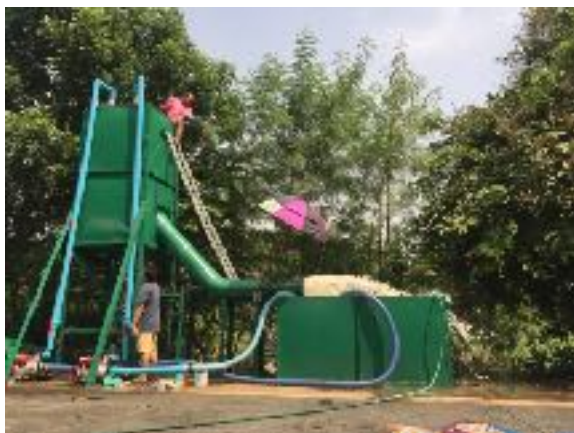
ภาพที่ 3 การทดสอบประสิทธิภาพกังหันน้ำหัวน้ำต่ำต้นแบบสำหรับผลิตกระแสไฟฟ้าขนาดเล็ก
