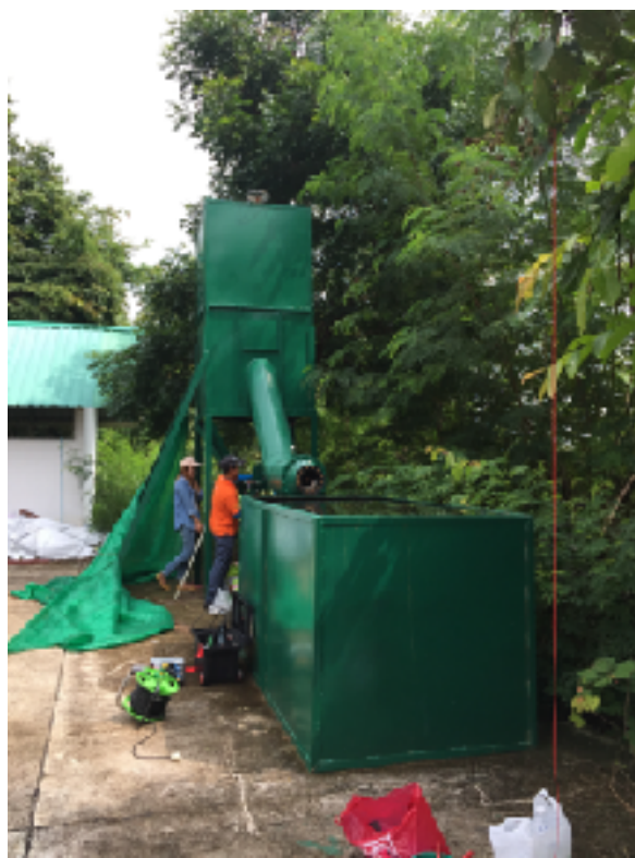
ภาพที่ 2 องค์ประกอบรวมของกังหันน้ำหัวน้ำต่ำต้นแบบสำหรับผลิตกระแสไฟฟ้าขนาดเล็ก
