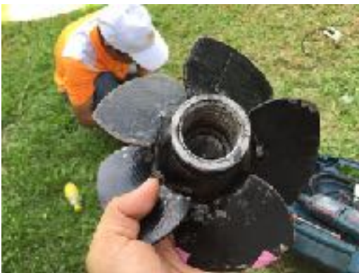
ภาพที่ 1 ใบกังหันน้ำและ ใบนำร่องทางเข้า (Guide vane) จำนวน 16 ช่อง
