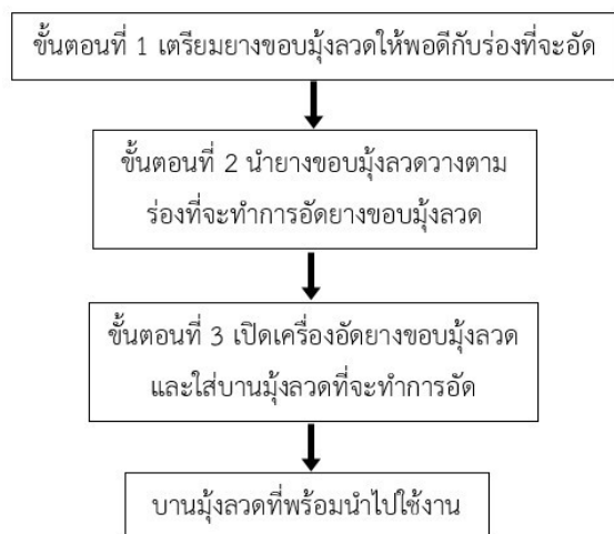
รูปที่ 2 แสดงขั้นตอนในการอัดยางขอบมุ้งลวด
