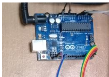
รูปที่ 8 ไมโครคอนโทรลเลอร์ Arduino UNO ควบคุมการทำงานของหุ่นยนต์
