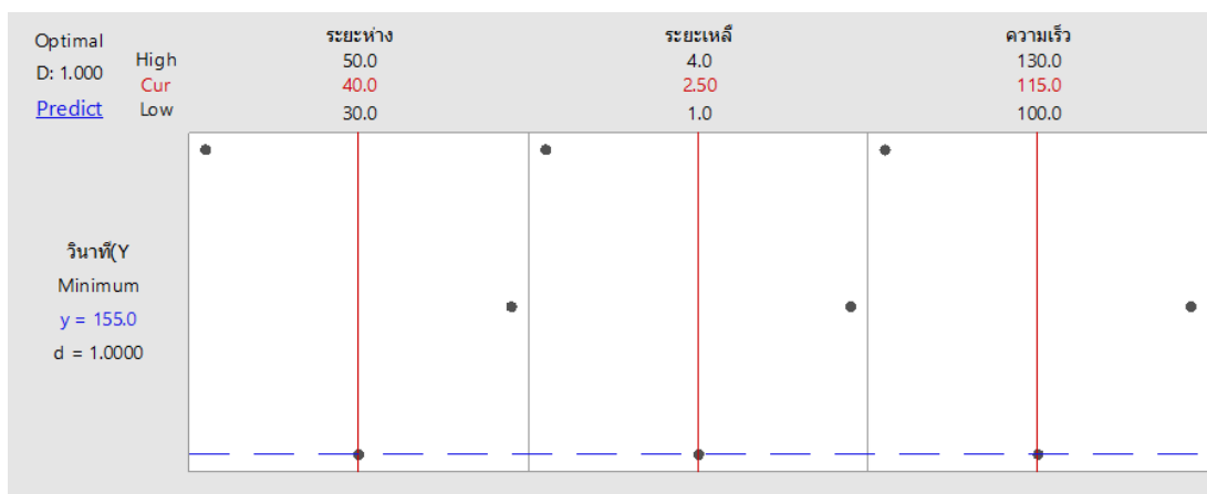
ภาพที่ 10 ค่าที่เหมาะสมในการปรับตั้งเครื่องหันใบตะไคร้
