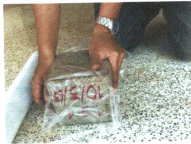
ภาพที่ 3 การบ่มแบบใช้พลาสติกคลุม
