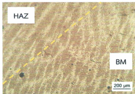
รูปที่ 9 การตรวจสอบโครงสร้างจุลภาคบริเวณ ที่ได้รับอิทธิพลจากความร้อน (HAZ) กับบริเวณรอยเชื่อม (WZ) ของลวดเชื่อม E120-18G
