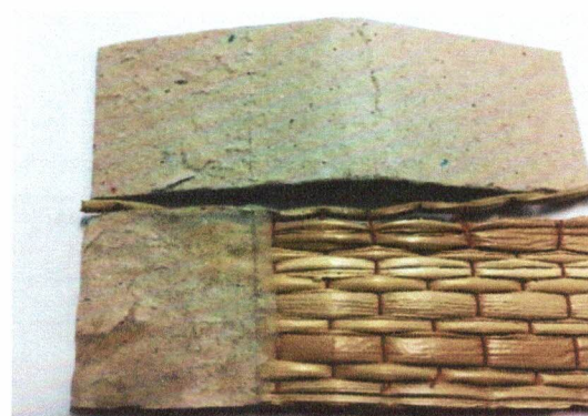
รูปที่ 8 ลักษณะการแตกหักของชั้นทดสอบเมื่อทดสอบแรงยึดติดแบบการลอกแบบตัวที (T-Peel)
