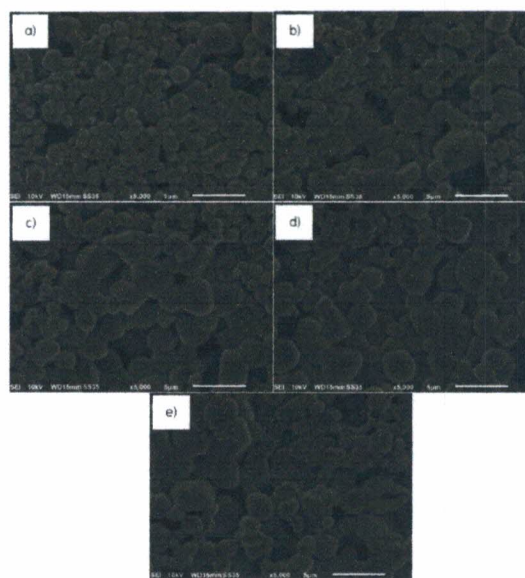
Figure 4 SEM images of CCTO: a) CCTO_STD, b) CCTO_AA10, c) CCTO_AA15, d) CCTO_AA25 and e) CCTO_AA50.
