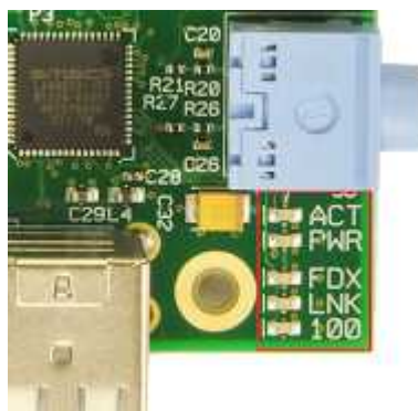
รูปที่ 2.50 จุดเชื่อมต่อสัญญาณเสียงและ LED แสดงสถานะของบอร์ด
