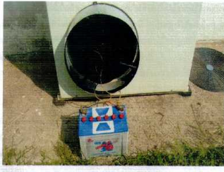
圖 3.26 電池連接至戶外熱水器
