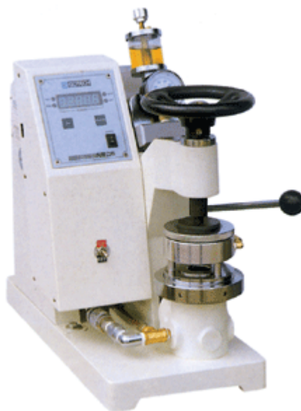
ภาพที่ 4.8 ภาพเครื่องมือในการทดสอบ Bursting Strength Tester
