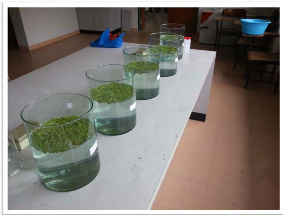
รูปที่ 2 ชุดการทดลองการกำจัดฟอสฟอรัสในน้ำเสีย
