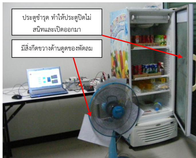
รูปที่ 4-3 การตรวจวัดปริมาณการใช้ไฟฟ้าและคุณภาพไฟฟ้า ณ จุดติดตั้ง ในสภาวะผิดปกติตามเหตุการณ์จำลอง
