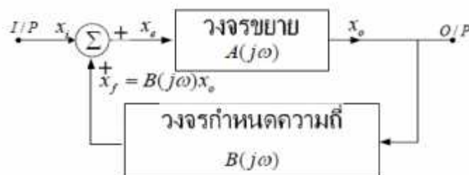
ภาพที่ ๒.๘ บล็อกไดอะแกรมของวงจรที่มีการป้อนกลับแบบบวก
