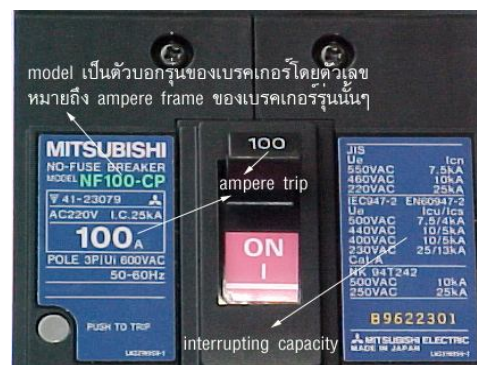
ภาพที่ 2.34 Name plate ปรากฏที่ด้านหน้าหรือด้านข้างของเบรกเกอร์
