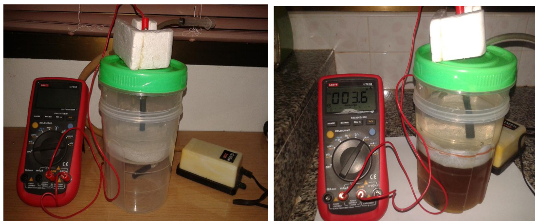
รูปที่ 4.1 แสดงลักษณะและส่วนประกอบของชุดเซลล์เชื้อเพลิงจุลชีพระดับห้องปฏิบัติการ
