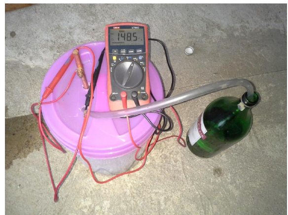
รูปที่ 4.3 แสดงลักษณะและอุปกรณ์ของเซลล์ไฟฟ้าเชื้อเพลิงจุลชีพระดับภาคสนาม
