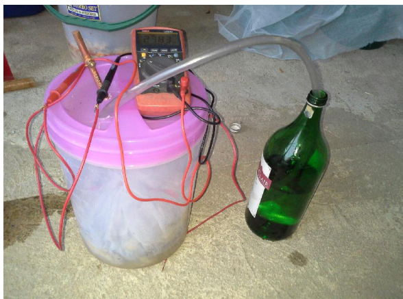
รูปที่ 4.3 แสดงลักษณะและอุปกรณ์ของเซลล์ไฟฟ้าเชื้อเพลิงจุลชีพระดับภาคสนาม
