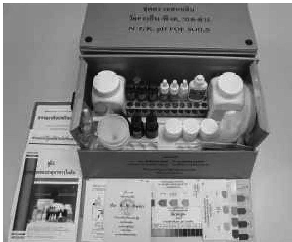
ภาพผนวกที่ 3 ชุดทดสอบดินที่ใช้ทดลองหาปริมาณธาตุอาหาร
