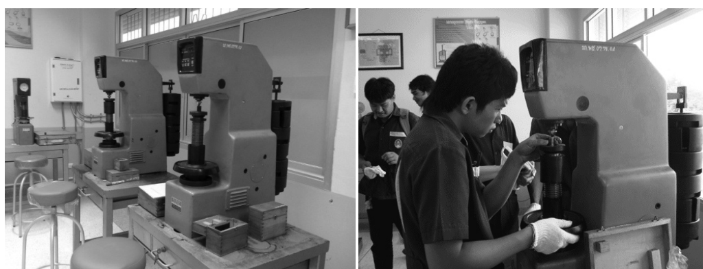
ภาพที่ ข.3 แสดงเครื่องวัดความแข็งแบบบริเนลและการทดสอบ
