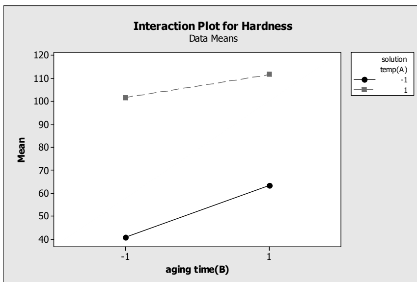
ภาพที่ 4.2 กราฟแสดงค่าความแข็งเฉลี่ยของอิทธิพลร่วมระหว่างอุณหภูมิอบละลายกับเวลาบ่ม
