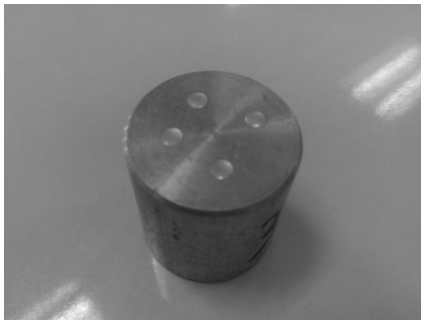
ภาพที่ 3.10 แสดงตัวอย่างรอยกดขึ้นงาน หัวกด 10 มม.
