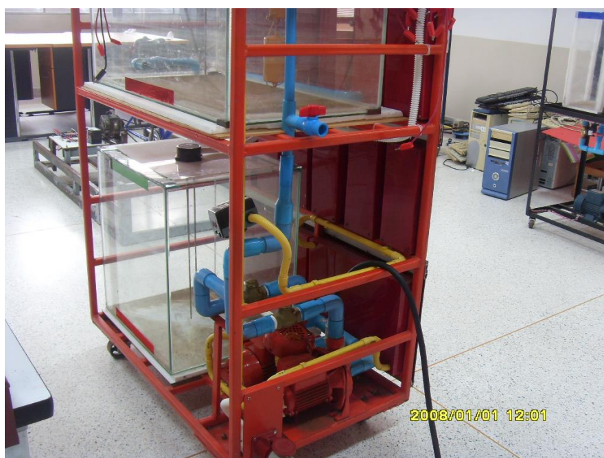
ภาพที่3.3 แสดงโครงสร้างปั้มน้ำอาคารน้ำอาคารสูงด้านหลังประกอบเครื่องสูบน้ำ
