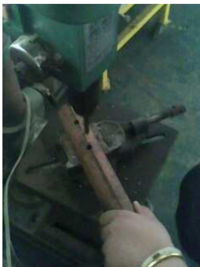
ภาพที่ 3-2 รูปการเจาะรูยึดของแผงโซล่าเซลล์
