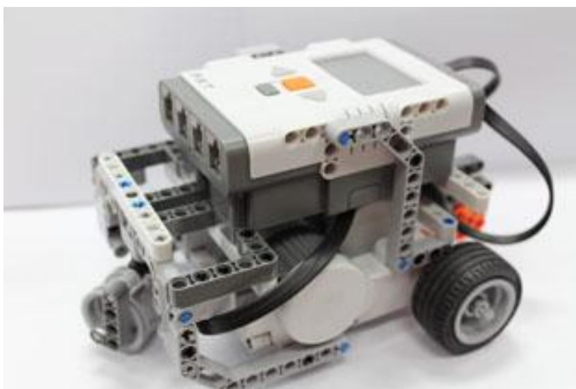
ภาพที่ 22 การออกแบบส่วนขับเคลื่อนของหุ่นยนต์ส่วนล้อหน้า
