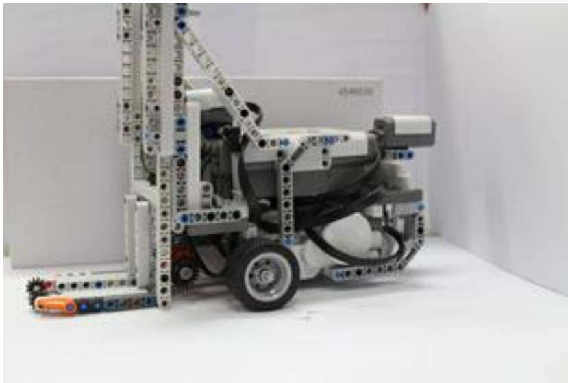
ภาพที่ 23 การออกแบบโครงสร้างของหุ่นยนต์ส่วนยกวัตถุด้านข้าง
