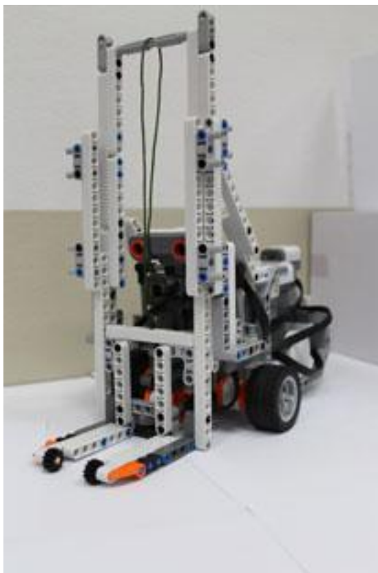
ภาพที่ 24 การออกแบบโครงสร้างของหุ่นยนต์ส่วนยกวัตถุด้านหน้า
