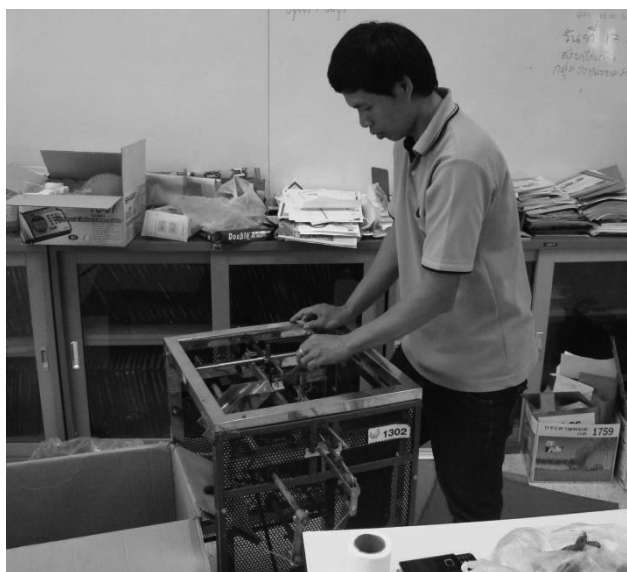
ภาพที่ 21 ดำเนินการทดสอบการถอดรแกะมะขามด้วยชุดถอดรแกะมะขาม
