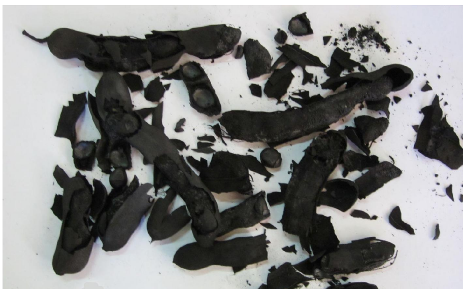
รูปที่ 4.3 แสดงลักษณะของถ่านของฟีกมะขามที่ผ่านกระบวนการคาร์บอนในเซชัน
