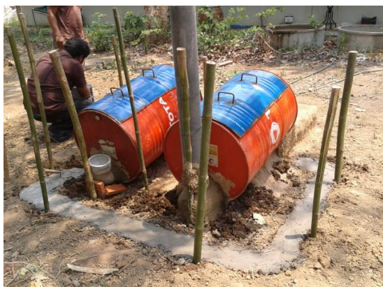
รูปที่ 4.2 การประกอบเตาภูมิปัญญาชาวบ้านเพื่อใช้ในการเผาถ่าน
