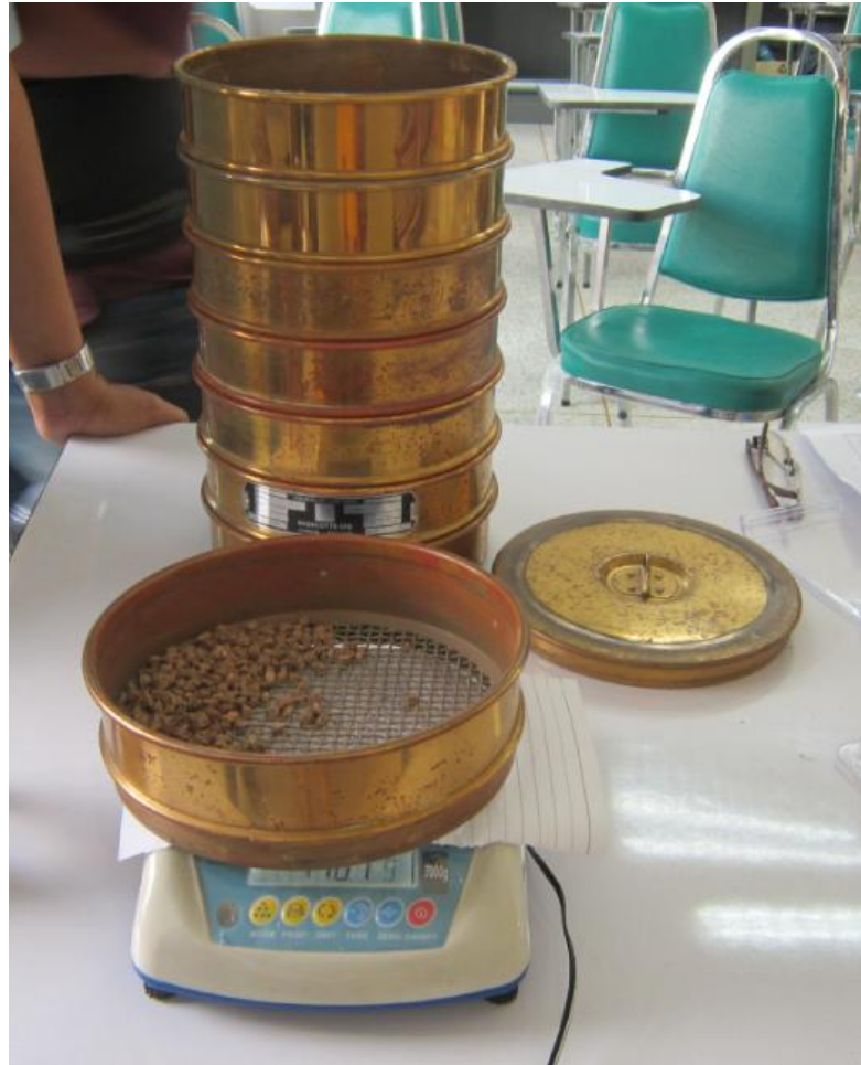
รูปที่ 2.14 แสดงการนำตะแกรงไปชั่งในแต่ละตะแกรง
