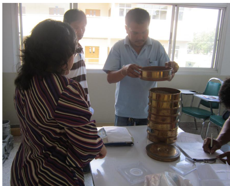
รูปที่ 2.13 แสดงการนำตะแกรงไปชั่งน้ำหนักดินค้างรวมตะแกรง
