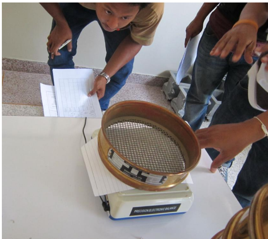
รูปที่ 2.16 แสดงนำตะแกรงใส่ตัวอย่างเปล่าไปชั่งและหักกลบน้ำหนักของตะแกรงเปล่า ออกทำการจดบันทึกน้ำหนักไว้
