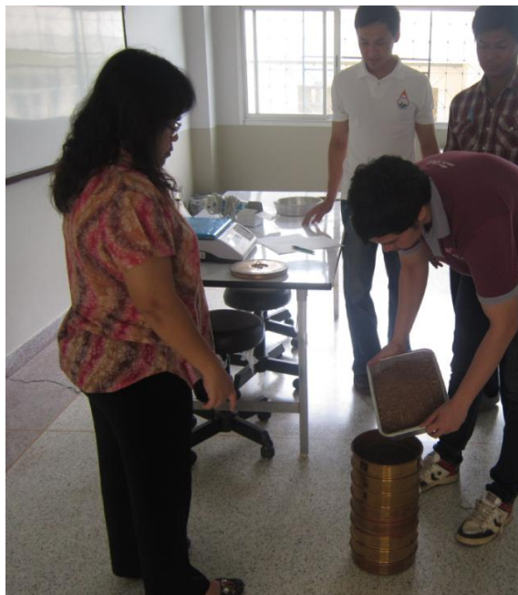
รูปที่ 2.9 แสดงการนำตัวอย่างดินแห้งเทใส่ลงบนตะแกรงอันบนสุด
