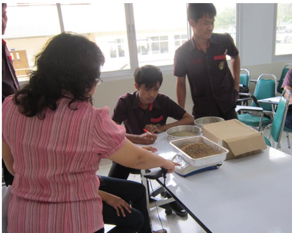
รูปที่ 2.7 แสดงปริมาณตัวอย่างทดสอบอย่างน้อย 1,000 กรัม ไปชั่งและบันทึกน้ำหนัก
