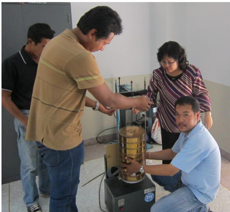
รูปที่ 2.12 แสดงการนำตะแกรงออกจากเครื่องเซย่า
