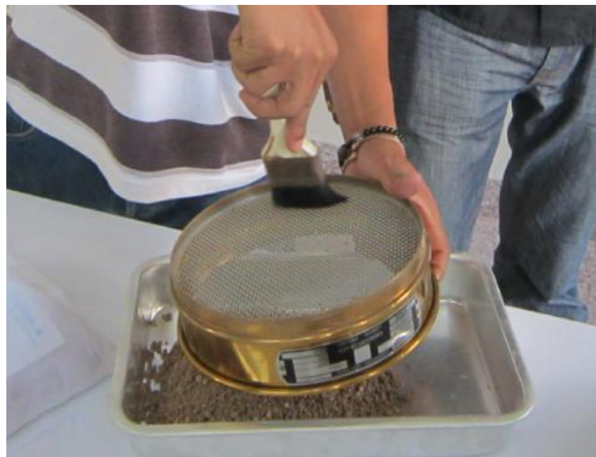
รูปที่ 2.15 แสดงการเทตัวอย่างจากตะแกรงลงในถาดโดยใช้แปรงปัด
