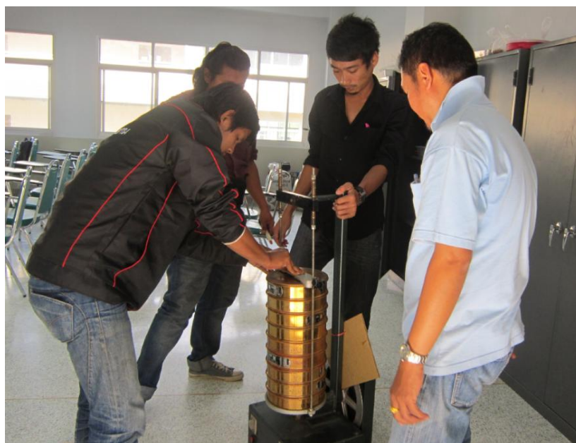
รูปที่ 2.10 แสดงการนำชุดตะแกรงเข้าเครื่องเขย่า
