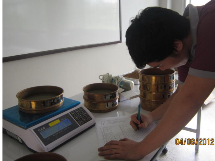
รูปที่ 2.8 แสดงการชั่งน้ำหนักตะแกรงขนาดต่าง ๆ และจดบันทึกน้ำหนักตะแกรง
