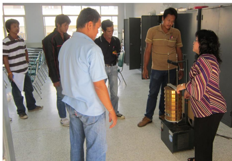
รูปที่ 2.11 แสดงการปฏิบัติการทดสอบวิเคราะห์ขนาดของดินเม็ดหยาบ โดยวิธีตะแกรงร่อน ในเครื่องเขย่า ประมาณ 10 - 15 นาที
