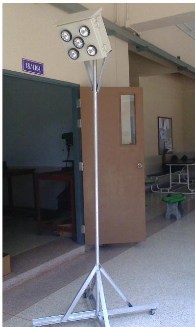
ภาพที่ 4.1 แสดงการทดสอบการทำงานอัตโนมัติของชุดโคมหลอดแอลอีดีสำหรับกักกันลมผลิตไฟฟ้าในเวลากลางวัน
