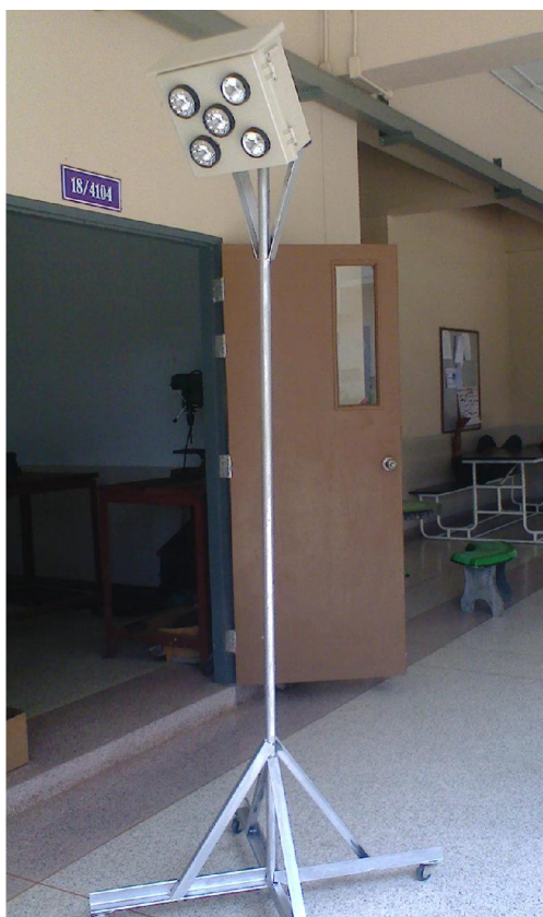
ภาพที่ 3.4 ขั้นตอนการสร้างฐานของชุดโคมให้มีล้อสำหรับการเคลื่อนย้าย เมื่อได้ฐานและโครงสำหรับชุดโคมหลอดแอลอีดีสำหรับกักเก็บลมผลิตไฟฟ้า จากนั้นนำตู้คอนโทรลและโคมหลอด LED ประกอบกับโครงของชุดโคม จึงได้ชุดโคมหลอดแอลอีดีสำหรับกักเก็บลมผลิตไฟฟ้า สำเร็จพร้อมนำไปทดสอบและใช้งานได้ ดังภาพที่ 3.5
