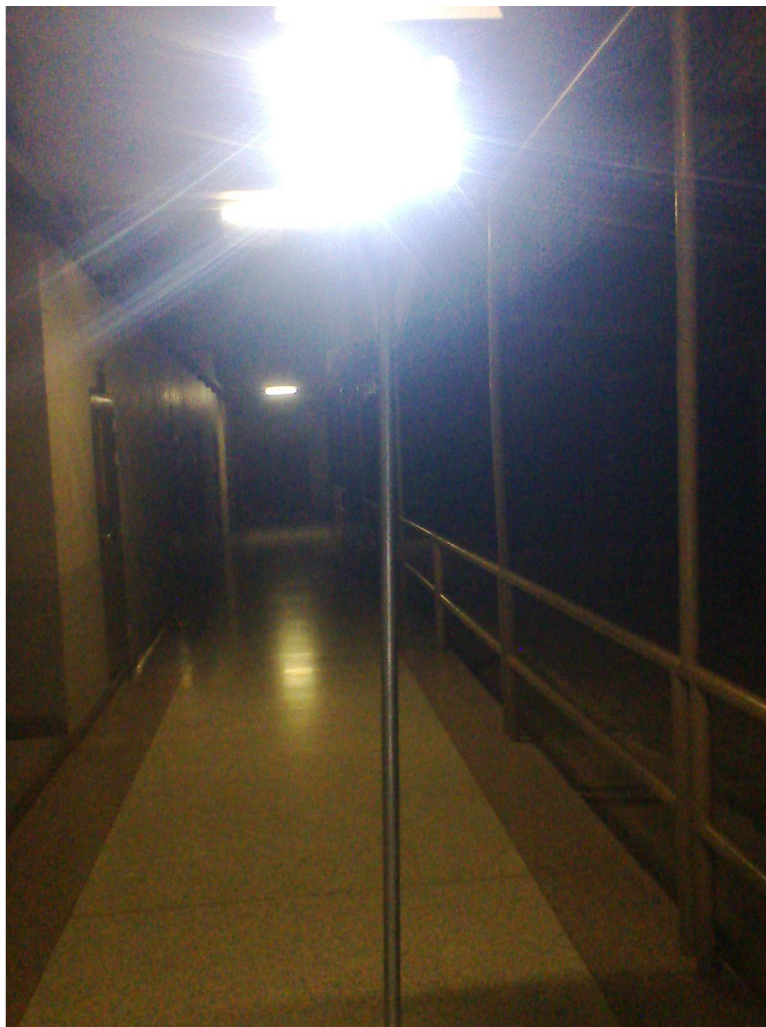
ภาพที่ 3.8 แสดงการทดสอบการจ่ายพลังงานไฟฟ้าให้กับโหลดของแบตเตอรี่
