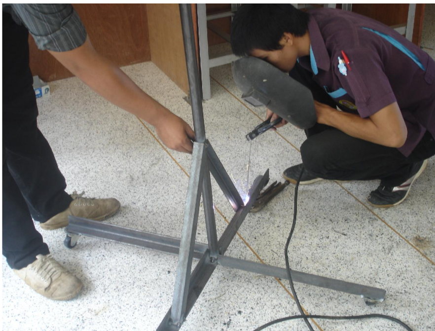
ภาพที่ 3.4 ขั้นตอนการสร้างฐานของชุดโคมให้มีล้อสำหรับการเคลื่อนย้าย เมื่อได้ฐานและโครงสำหรับชุดโคมหลอดแอลอีดีสำหรับกักเก็บลมผลิตไฟฟ้า จากนั้นนำตู้คอนโทรลและโคมหลอด LED ประกอบกับโครงของชุดโคม จึงได้ชุดโคมหลอดแอลอีดีสำหรับกักเก็บลมผลิตไฟฟ้า สำเร็จพร้อมนำไปทดสอบและใช้งานได้ ดังภาพที่ 3.5
