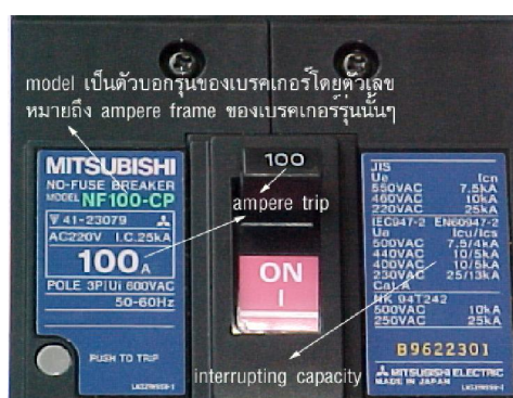
ภาพที่ 2.7 Name plate ปรากฏที่ด้านหน้าหรือด้านข้างของเบรกเกอร์
