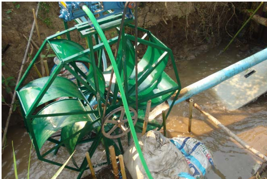
รูปที่ 7 การทดสอบประสิทธิภาพกังหันน้ำ
