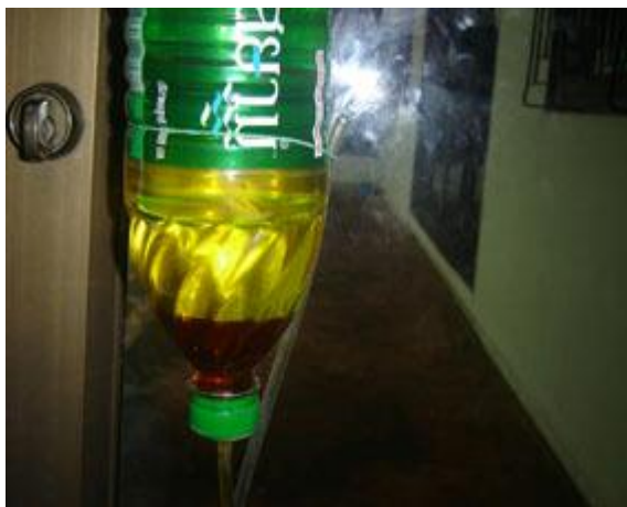
การทิ้งไว้ให้กลีเซอรินตกตะกอนภายหลังจากปฏิกิริยา
