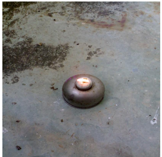
การติดไฟของน้ำมันไบโอดีเซลที่เตรียมได้
