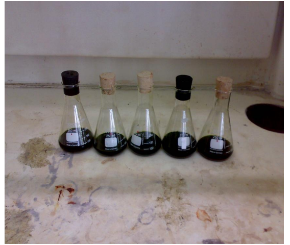
การสกัดน้ำมันจากสาหร่ายโดยการแช่ในเฮกเซน
