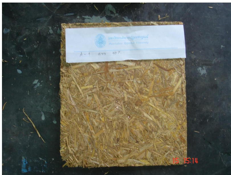
ภาพที่ 15 แผ่นวัสดุจากฟางข้าวที่ผ่านการอัดร้อน
