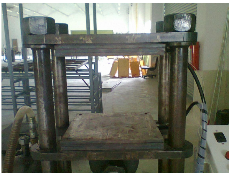
ภาพที่ 14 แสดงการอัดขึ้นรูปเป็นแผ่นเรียบขนาดกว้าง 20 ซม. ยาว 20 ซม.หนา 1 ซม.
