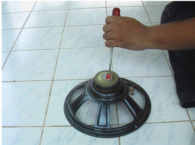
ภาพที่ 3.6 การตอกแม่เหล็กออกจากโครงของตัวลำโพง
