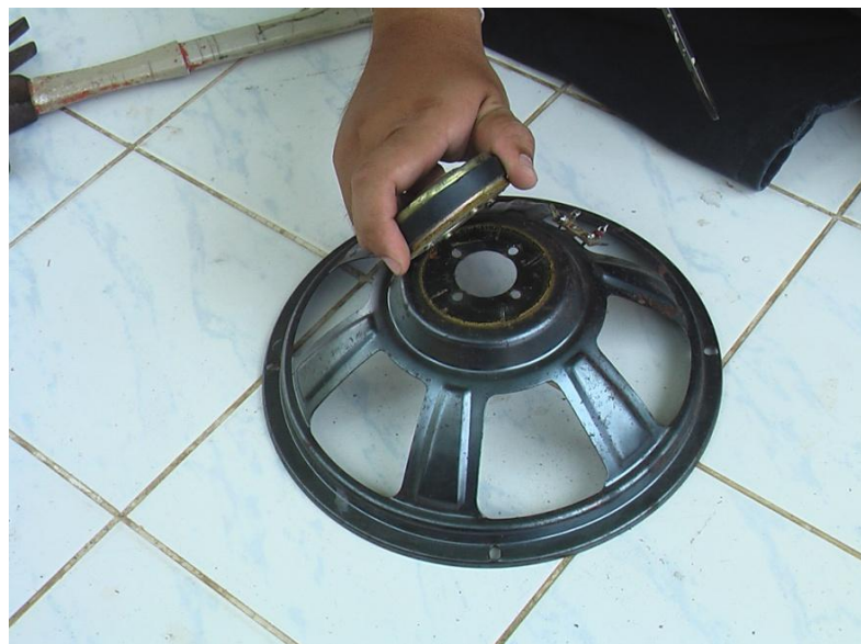
ภาพที่ 3.9 เมื่อตอกแม่เหล็กออกจากโครงลำโพงแล้ว
