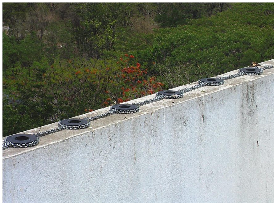
ภาพที่ 4.1 ลักษณะชุดไล่นกด้วยแม่เหล็กเหลือใช้ที่ทดลองเพื่อประเมินประสิทธิภาพ
