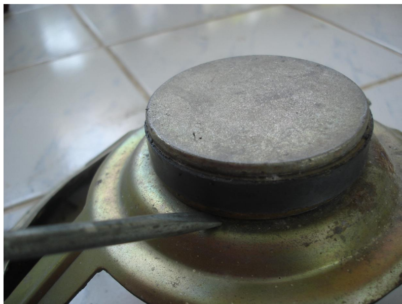
ภาพที่ 3.7 ใช้ไขควงเพื่อตอกแม่เหล็กออกจากโครงของตัวลำโพง
