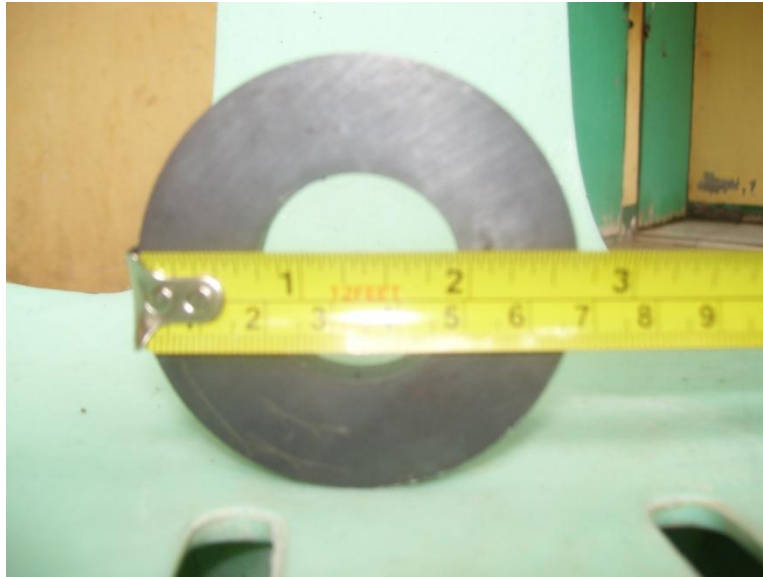
ภาพที่ 3.14 แม่เหล็กถาวรขนาดเส้นผ่าศูนย์กลาง 6.8 เซนติเมตร หนา 1 เซนติเมตร
