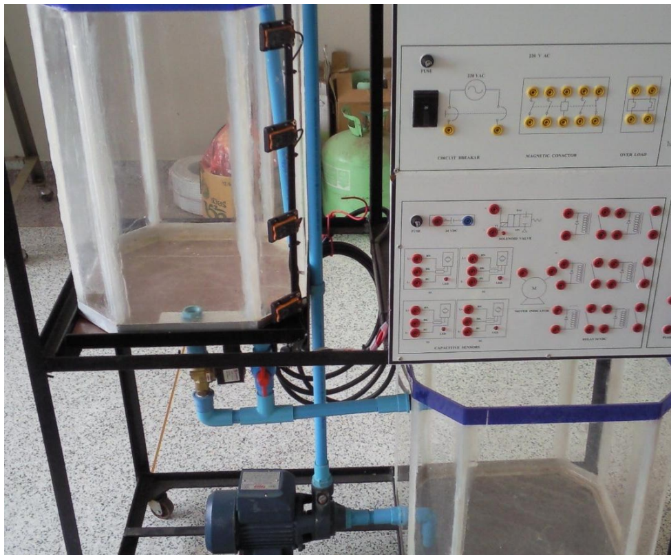
ภาพที่ 5.1 ชุดสาธิตการควบคุมปริมาณและแสดงระดับน้ำด้วยคอมพิวเตอร์
