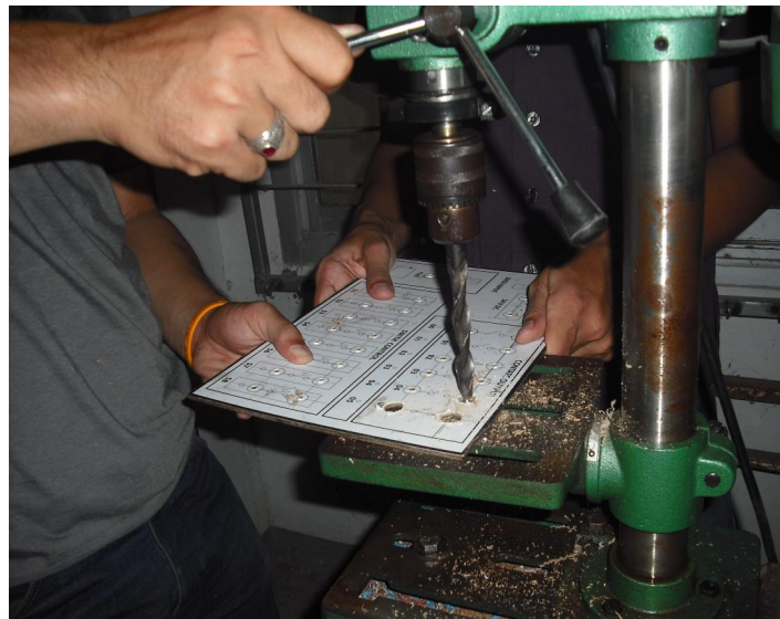
ภาพที่ 3.17 ภาพถ่ายการสร้างแผงหน้าของวงจรอินเทอร์เฟส
