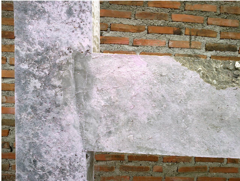
รูปที่ ก1 ลักษณะการวิบัติของคาน B1
