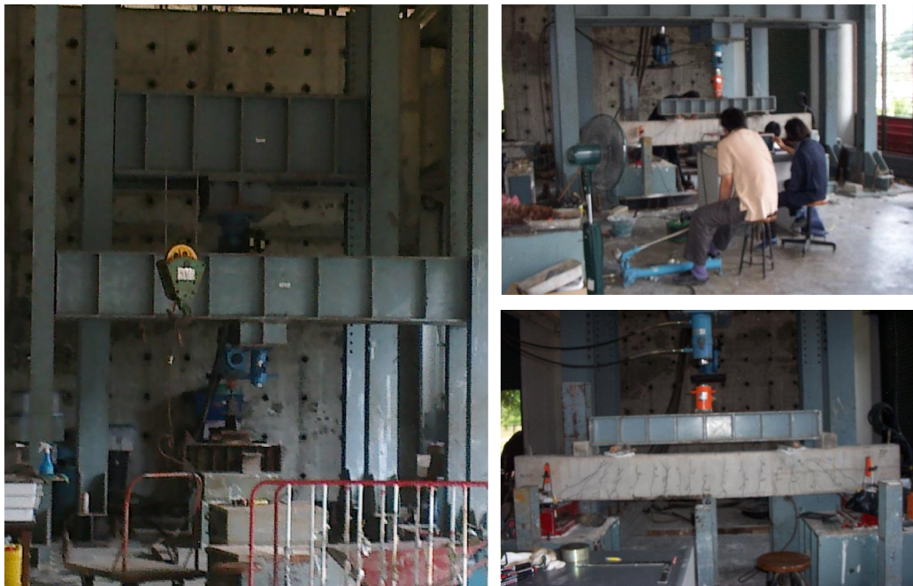
รูปที่ 3.2 เครื่องทดสอบกำลังรับแรงของคานตัวอย่าง
