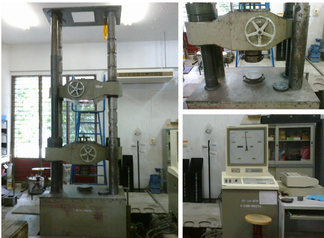
รูปที่ 3.1 เครื่องทดสอบกำลังรับแรงอัดและแรงดึงของวัสดุที่ใช้ในการทดสอบ
