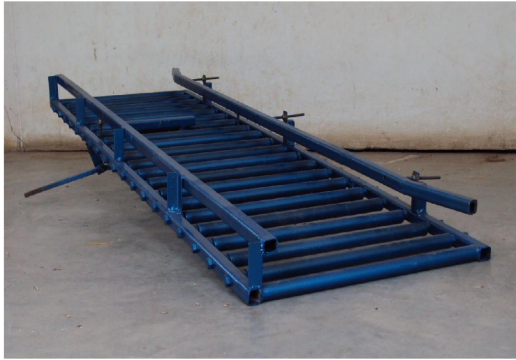
ภาพที่ 3.5 ภาพรางเลื่อนลาดกรอกดิน
