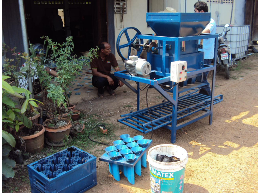
ภาพที่ ช-12 นำถุงกล้ายางพาราออกจากชุดกรอก
