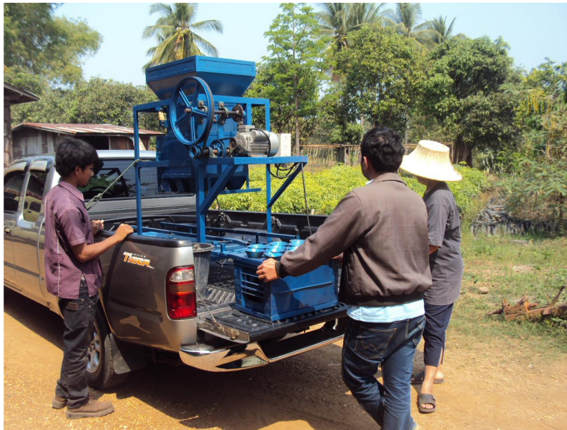
ภาพที่ ช-4 ผลผลิตของเครื่องที่สามารถกรอกดินใส่ถุงเพาะชำกล้าอย่างพาราสำเร็จตามวัตถุประสงค์
