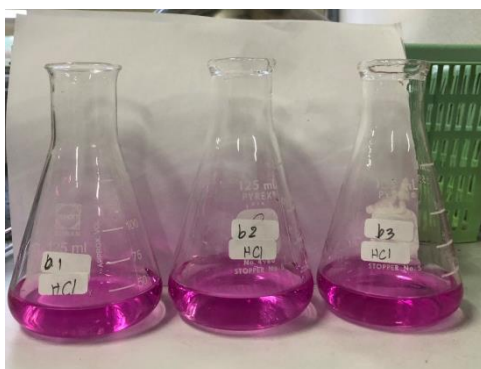
ภาพที่ ผก 11 สีของสารละลายที่ทำการไทเทรตเพื่อศึกษาความเป็นเบสของฟีนีล
