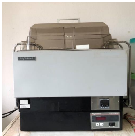
ภาพที่ ผก 3 เครื่องควบคุมอุณหภูมิแบบเขย่า (Shaking Water bath)
