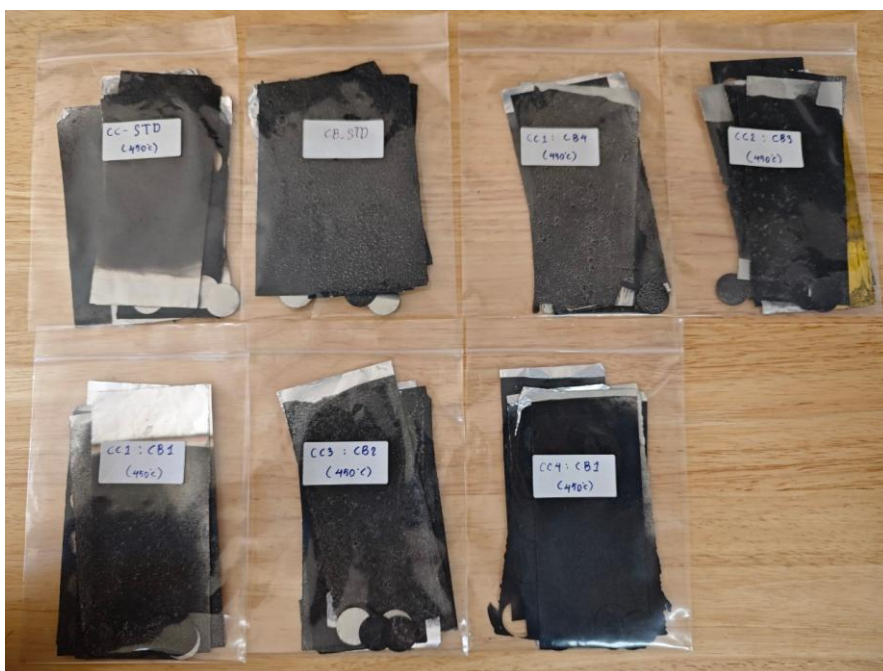
ภาพที่ 3.5 ฟิล์มคาร์บอนใช้เป็นขั้วไฟฟ้าของตัวเก็บประจุไฟฟ้ายิ่งยวด
