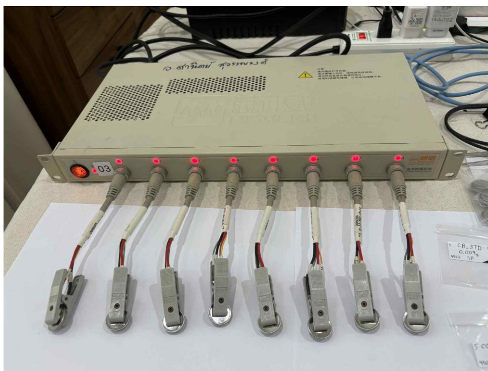
ภาพที่ 3.9 เครื่อง Battery Testers system
