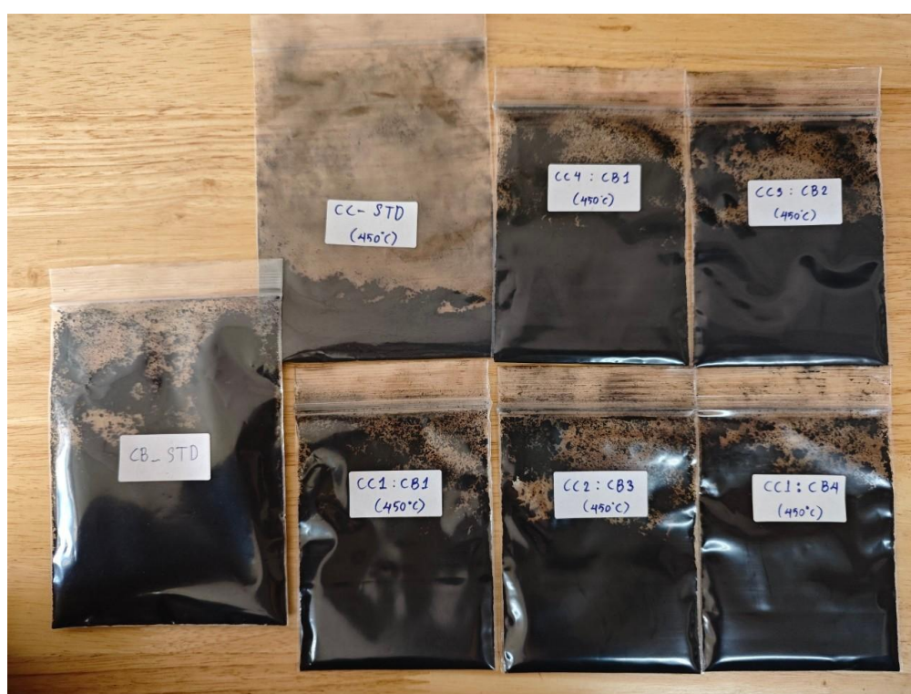
ภาพที่ 3.3 ถ่านคาร์บอนจากซังข้าวโพดที่ผสมกับคาร์บอนแบล็คด้วยเครื่องบด ball mill
