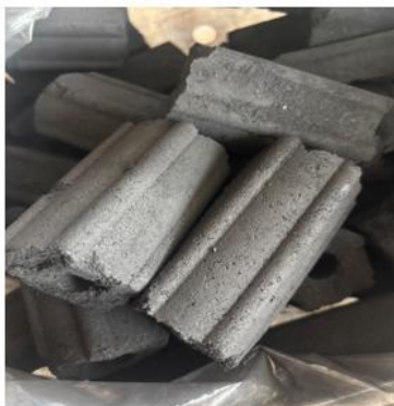
รูปที่ 4.12 ผลิตภัณฑ์ถ่านอัดแท่งจากเศษกะลาแมคคาเดเมียที่ได้จากกระบวนการเตรียมถ่านอัดแท่งระดับอุตสาหกรรมครัวเรือน และการทดลองจุดติดไฟเพื่อให้ความร้อน
