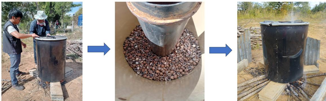
รูปที่ 4.9 ขั้นตอนการเตรียมถ่านจากเศษกะลาแมคคาเดเมียโดยใช้กระบวนการไพโรไลซิสโดยใช้เตาเผาถ่านถั่วถั่วขนาดเล็ก 200 ลิตร
