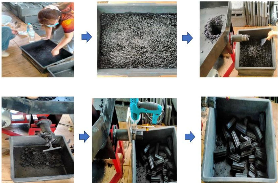
รูปที่ 4.11 แสดงขั้นตอนของการผสมถ่านตามสูตรการผสมที่กำหนด การนวดเศษถ่านและการอัดแท่ง เพื่อขึ้นรูปถ่านอัดแท่งจากเศษกะลาแมคคาเดเมีย
