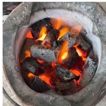
รูปที่ 4.12 ผลิตภัณฑ์ถ่านอัดแท่งจากเศษกะลาแมคคาเดเมียที่ได้จากกระบวนการเตรียมถ่านอัดแท่งระดับอุตสาหกรรมครัวเรือน และการทดลองจุดติดไฟเพื่อให้ความร้อน
