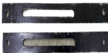
ภาพที่ 3.22 การออกแบบฐานยึดมอเตอร์
