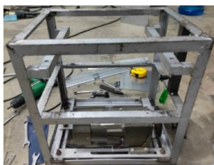
ภาพที่ 3.18 โครงสร้างเครื่องปั่นเนื้อมะขามแก้ว
