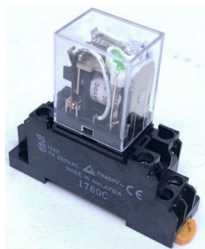
ภาพที่ 2.6 รีเลย์ควบคุมมีขนาดเล็กกำลังไฟฟ้าต่ำ
