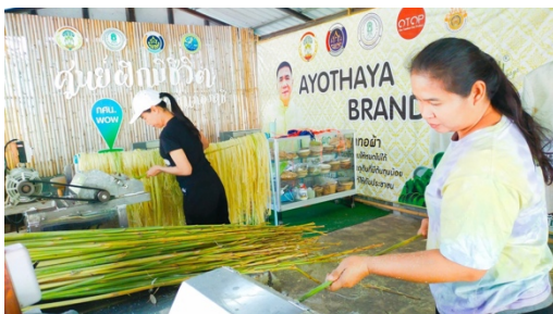
ภาพที่ 4-4 การป้อนต้นข้าวเข้าเครื่องแยกเส้นใย
