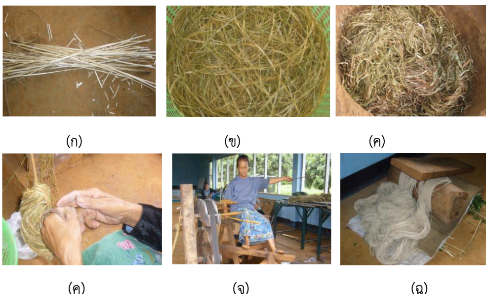
ภาพที่ 2-6 กระบวนการแยกเส้นใยกัญชงด้วยมือ
