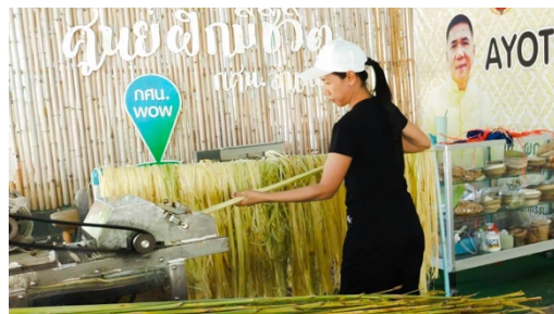
ภาพที่ 4-4 การป้อนต้นข้าวเข้าเครื่องแยกเส้นใย
