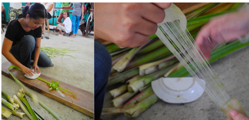
ภาพที่ 2-7 การแยกสกัดเส้นใยสับปะรด
