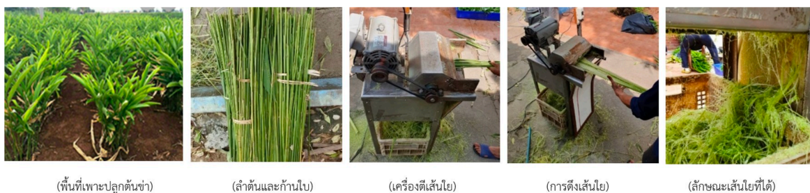
ภาพที่ 2-3 กระบวนการแยกเส้นใยข่า
