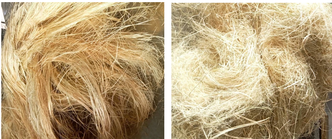
ภาพที่ 4-8 เส้นใยข้าแห้งจากการตีแยกสกัดเส้นใย
