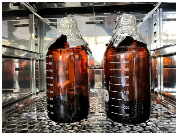
รูปที่ 3.14 สารสกัดใบกัญชงเข้าสู่ตู้ควบคุมอุณหภูมิแบบแห้ง (Constant Temperature oven) ที่อุณหภูมิ 40-45 องศาเซลเซียส เพื่อระเหยเอทานอลร้อยละ 95 ออกอีกรอบ (ที่มา: คณะผู้วิจัย, 2023)
