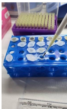
3. เตรียมกรดแอสคอร์บิกเป็นสารมาตรฐานที่ความเข้มข้น 20, 30, 40, 50 และ 60 ไมโครกรัมต่อมิลลิลิตร
