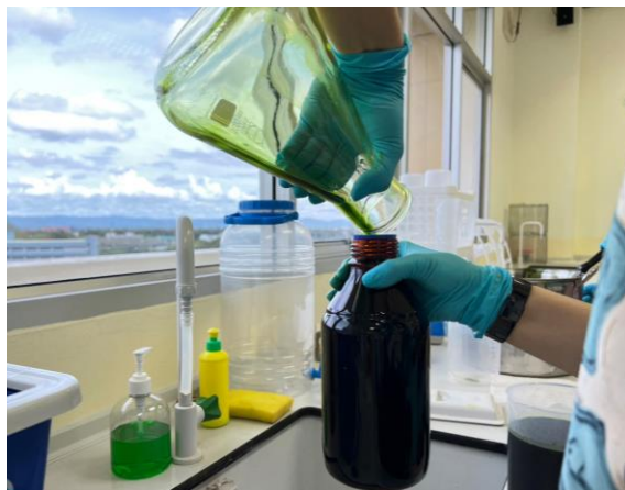
รูปที่ 3.9 นำสารละลายที่กรองเรียบร้อยแล้ว เทใส่ขวด Duran สีชา (ที่มา: คณะผู้วิจัย, 2023)
