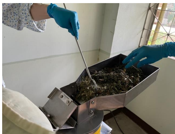
รูปที่ 3.3 การลดขนาดใบกัญชง (Hemp) ด้วยเครื่องบดผงสมุนไพรแบบละเอียด (ที่มา: คณะผู้วิจัย, 2023)
