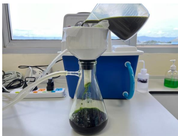
รูปที่ 3.8 ขั้นตอนการกรองสารละลายด้วยผ้าก๊อซและกระดาษกรอง Whatman เบอร์ 01 เป็นการกรองรอบที่ 2 (ที่มา: คณะผู้วิจัย, 2023)
