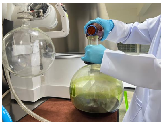
รูปที่ 3.12 นำสารละลายใบกัญชงเทใส่ขวดแก้วกลม เพื่อเตรียมเข้าเครื่องระเหยตัวทำละลายสุญญากาศบนอ่างน้ำควบคุมอุณหภูมิ (Rotary evaporator) (ที่มา: คณะผู้วิจัย, 2023)
