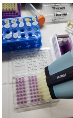
5. เตรียมสารละลาย FRAP reagent หลังจากนั้นเติมลงใน หลุมปริมาตร 182 ไมโครลิตร ตั้งไว้ 30 นาทีที่อุณหภูมิ 37 องศาเซลเซียส
