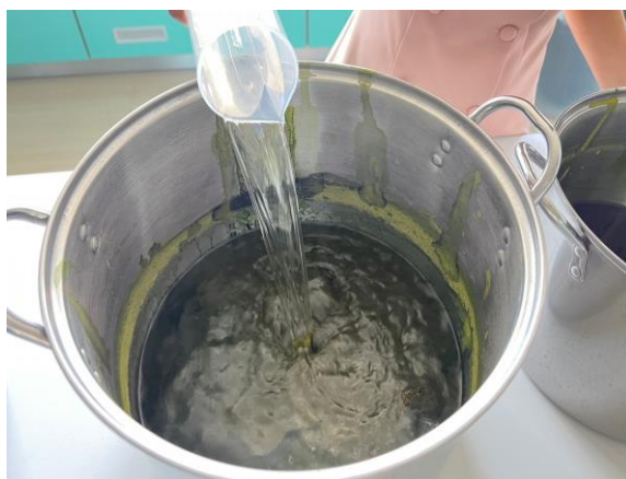
รูปที่ 3.10 ขั้นตอนการหมักเอทานอลร้อยละ 95 กับกากใบกล้วยที่เหลือจากการกรอง ทำการหมักซ้ำจนครบ 3 รอบ (ที่มา: คณะผู้วิจัย, 2023)
