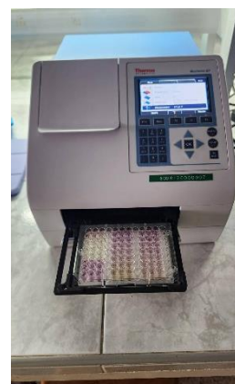
6. วัดค่าการดูดกลืนแสงด้วยเครื่องสเปกโตรโฟโตมิเตอร์ที่ ความยาวคลื่น 593 นาโนเมตร
