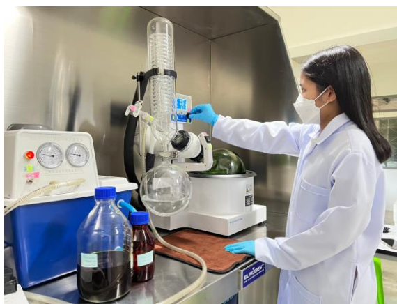
รูปที่ 3.13 นำสารละลายใบกัญชงเทเข้าเครื่องระเหยตัวทำละลายสุญญากาศบนอ่างน้ำควบคุมอุณหภูมิ (Rotary evaporator) เพื่อระเหยเอทานอล 95% ออก (ที่มา: คณะผู้วิจัย, 2023)
