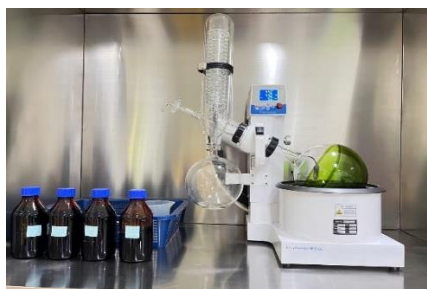
ภาพที่ 4.1 แสดงขั้นตอนการสกัดสารจากใบกัญชง
