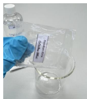
2. นำส่วนที่ 1 ใส่ปิกเกอร์ จากนั้นเริ่มต้นการละลายข้อ 1 และ 2 คนให้ละลาย
