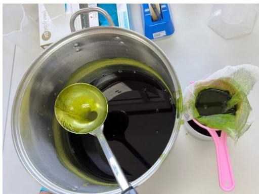
ภาพที่ 3.25 ขั้นตอนการกรองสารละลายด้วยผ้าก๊อซเป็นการกรองรอบที่ 1 (ที่มา: คณะผู้วิจัย, 2023)
