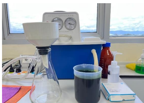
ภาพที่ 3.4 การกรองสารสกัดใบกล้วยงโดยกรองผ่านผ้าก๊อชและกระดาษกรอง Whatman No.1 โดยใช้เครื่องกรองสุญญากาศ (ที่มา:คณะผู้วิจัย, 2023)
