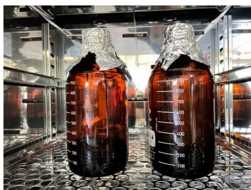
ภาพที่ 3.32 สารสกัดใบกล้วยชงเตเข้าสู่ตู้ควบคุมอุณหภูมิแบบแห้ง (Constant Temperature oven) ที่อุณหภูมิ 40-45 องศาเซลเซียส เพื่อระเหยเอทานอลร้อยละ 95 ออกอีกรอบ (ที่มา: คณะผู้วิจัย, 2023)
