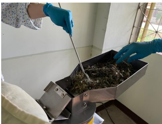
ภาพที่ 3.21 การลดขนาดใบกัญชง (Hemp) ด้วยเครื่องบดผงสมุนไพรแบบละเอียด (ที่มา: คณะผู้วิจัย, 2023)
