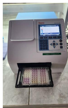
6. วัดค่าการดูดกลืนแสงด้วยเครื่องสเปกโตรโฟโตมิเตอร์ที่ ความยาวคลื่น 517 นาโนเมตร
