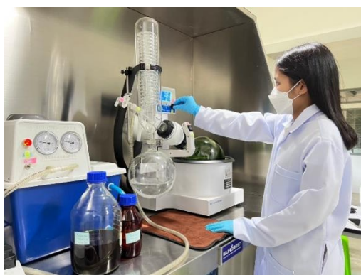
ภาพที่ 3.31 นำสารละลายใบกล้วยชงเตเข้าเครื่องระเหยตัวทำละลายสูญญากาศบนอ่างน้ำควบคุม อุณหภูมิ (Rotary evaporator) เพื่อระเหยเอทานอล 95% ออก (ที่มา: คณะผู้วิจัย, 2023)
