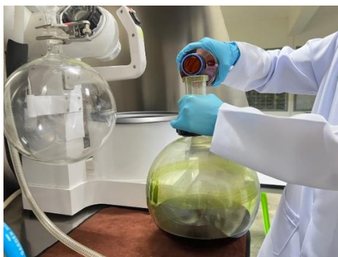
ภาพที่ 3.30 นำสารละลายใบกล้วยชงเตใส่ขวดแก้วกลม เพื่อเตรียมเข้าเครื่องระเหยตัวทำละลาย สูญญากาศบนอ่างน้ำควบคุมอุณหภูมิ (Rotary evaporator) (ที่มา: คณะผู้วิจัย, 2023)
