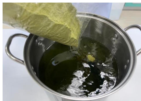
ภาพที่ 3.2 การบดใบกล้วยแห้งโดยใช้เครื่องบดใบกล้วยแบบละเอียดและหมักที่อุณหภูมิห้อง (ที่มา:คณะผู้วิจัย, 2023)
