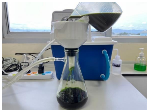
ภาพที่ 3.26 ขั้นตอนการกรองสารละลายด้วยผ้าก๊อซและกระดาษกรอง Whatman เบอร์ 01 เป็น การกรองรอบที่ 2 (ที่มา: คณะผู้วิจัย, 2023)
