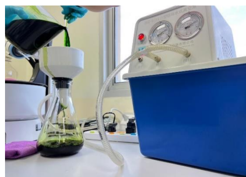
ภาพที่ 3.4 การกรองสารสกัดใบกล้วยงโดยกรองผ่านผ้าก๊อชและกระดาษกรอง Whatman No.1 โดยใช้เครื่องกรองสุญญากาศ (ที่มา:คณะผู้วิจัย, 2023)
