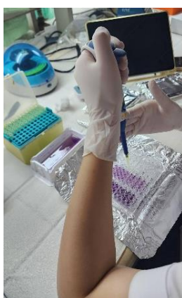
5. เติมสารละลาย DPPH ปริมาตร 180 ไมโครลิตร หลังจากนั้น นำไปไว้ในที่มืดเป็นเวลา 30 นาที
