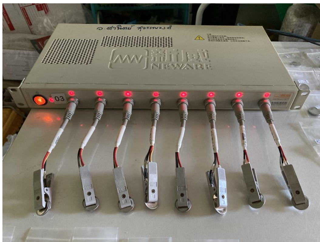
ภาพที่ 3.11 การวัดประสิทธิภาพของตัวเก็บประจุยิ่งยวดด้วยเครื่อง Battery Testers system
